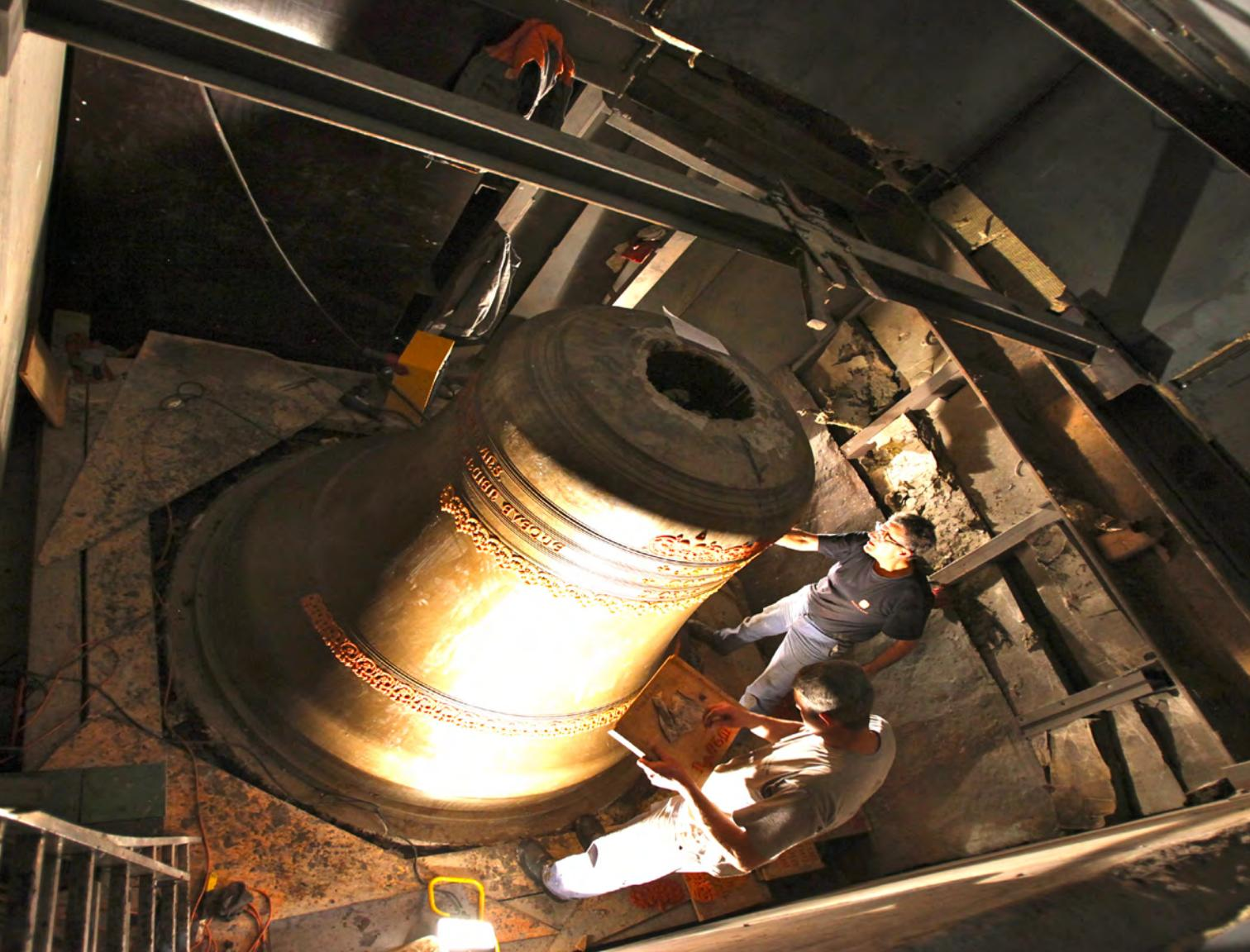
En haut et page de droite : fabrication de la fausse cloche, moule intermédiaire servant de support à la réalisation du moule et permettant d'aménager l'espace creux en forme de cloche, dans lequel sera versé le bronze en fusion. Ce moule figure la future cloche, dont il possède les mêmes dimensions.
