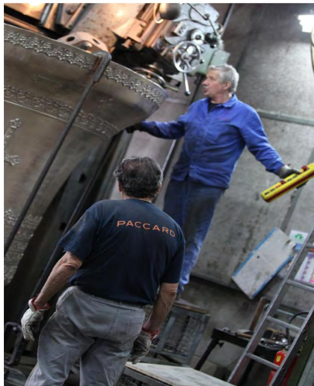
Réglage du tour avant accordage ; à droite : accordage de la Jeanne-d'Arc. Le bourdon est placé à l'envers sur un tour vertical, afin d'enlever, avec d'innombrables précautions, un peu de métal à l'intérieur de la cloche pour en ajuster parfaitement chacun des harmoniques qui en composent le timbre.
