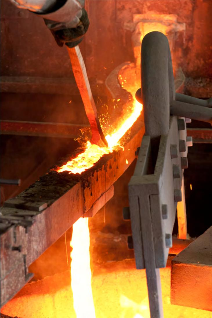
Le métal utilisé est un bronze particulier appelé airain ou bronze de cloche. C'est un alliage de 78 % de cuivre et de 22 % d'étain, fondu et contrôlé à la cinquième heure de chauffe. Il est porté à une température de plus de 1 000 °C.
