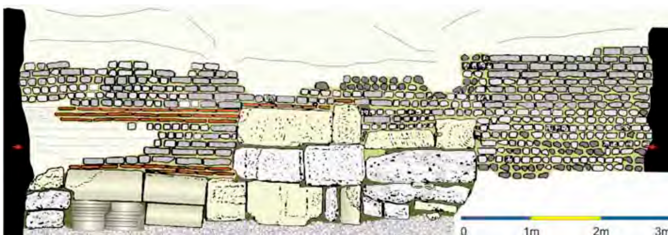
Évreux, Théâtre municipal : Relevé de la face interne du rempart dans sa partie la mieux conservée. Les altitudes sont données dans le corps de la notice. On remarquera l'anomalie dans la fondation qui comporte trois assises de blocs. (É. Follain)
