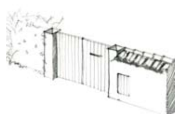
Portail avec sommet droit et intégration dans le mur de la logette EDF.
