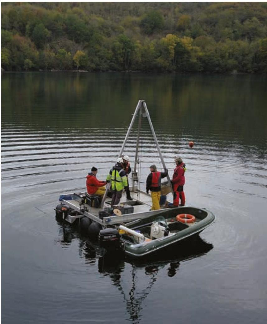
[1] Réalisation d'un carottage à partir d'une plateforme de forages Uwitec®.
