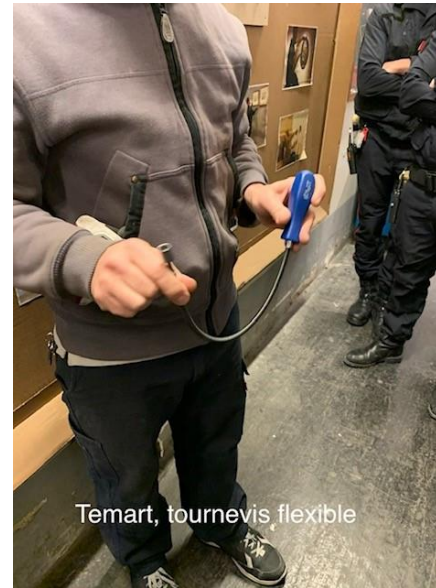
Tournevis flexible pour les systèmes d'accrochage sécurisé
