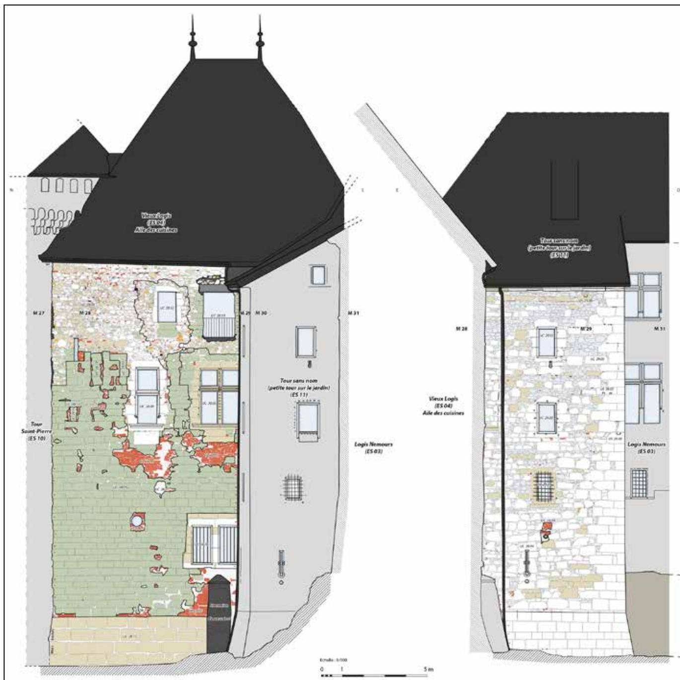
Figure 2 : Château d'Annecy, élévations de l'Aile des cuisines et de la Tour « sans nom ». DAO : E. Chauvin-Desfleurs.
