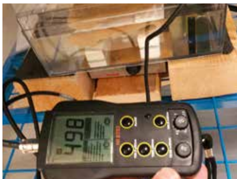
(fig. 4) Conductimètre utilisé pour le suivi d'un dessalement par bains.
