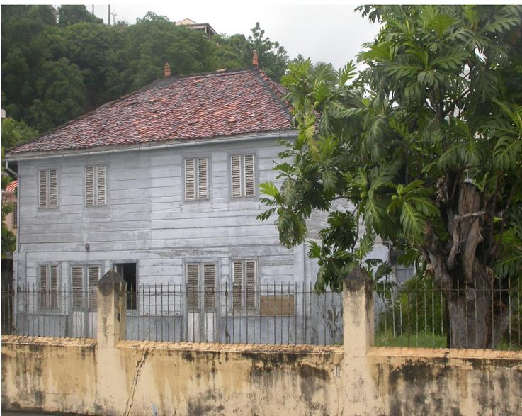
La couverture est réalisée par une toiture, à croupe, en tuile plate à écaille reposant sur une charpente en bois. Deux épis de faîtage viennent couronner l'ensemble.
