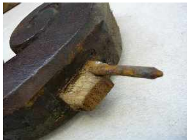
3- Exemple d'assemblage défectueux renforcé par un clou.
