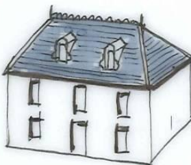
Exemple de toiture à quatre pan, façade à trois travées
