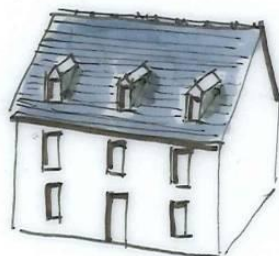
Exemple de toiture à deux pans, façade à trois travées
