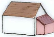
Extensions en appentis contre le pignon (léger décroché)
