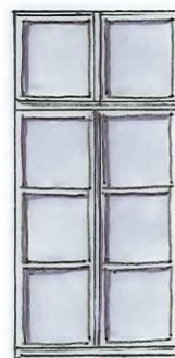
Fenêtre XXe siècle avec imposte vitrée et croisillons mais grands carreaux
