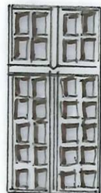
Fenêtre du XVIIe siècle avec imposte et petit carreaux. Croisillon en bois.
