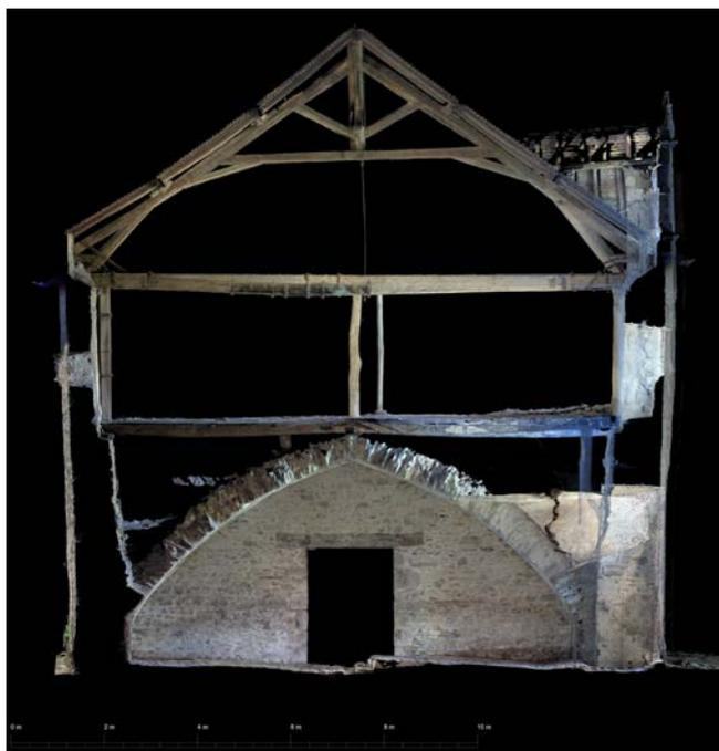
Fig.1 : Ecuries du château des Cars : relevé/coupe transversale montrant les différents niveaux intérieurs du bâtiment, dont le reliquat de voûte du rez-de-chaussée (lasergrammétrie : E. Balbo, Archéoscan/ArchéA).
