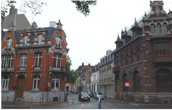
3. Rue du lieutenant Colpin prolongée par la 4. rue Voltaire : pavés sur les trottoirs, enrobé sur les stationnements et la bande roulante
