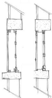
Les volets s'ajustent à l'intérieur du cadre. Les pierres sont taillées ou un cadre de bois est posé pour bloquer les volets
