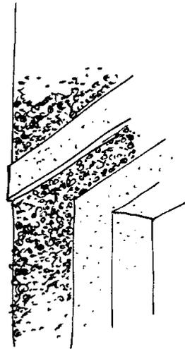
*En nuancant la finition d'un enduit (lissé, brossé, taloché), on peut en varier l'aspect sur différentes parties du bâtiment.*
