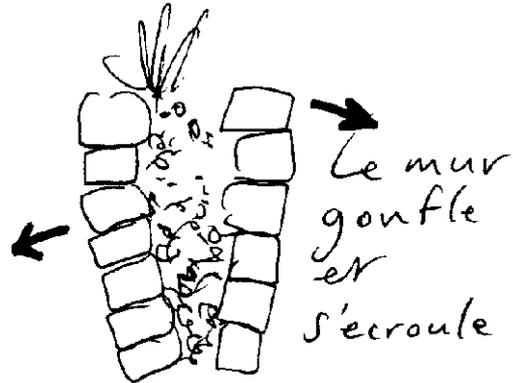
Le joint creux fragilise le mur ; le joint beurré – ou à fleur de moellon – quitte à le couvrir légèrement ou l'enduit assurent une bonne protection. Un badigeon de lait de chaux peut compléter la protection en bouchant les micro-fissures ; il unifie la façade et estompe les défauts.
