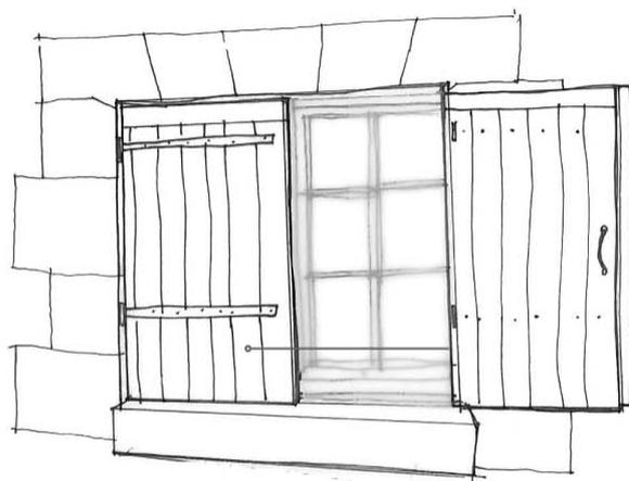
Fenêtre courante : rectangulaire, volets battants bien ajustés, équerre extérieure au nu du bois. Vient s'ajuster à l'intérieur du cadre.
