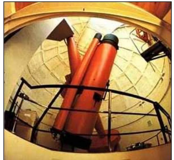
L'observatoire et les lunettes jumelles du PPO (petit prisme objectif) est un exemplaire unique d'une lunette doublée d'un prisme. Il a été installé en 1946 et permettait de mesurer la vitesse radiale des étoiles. Il est actuellement inutilisé.
