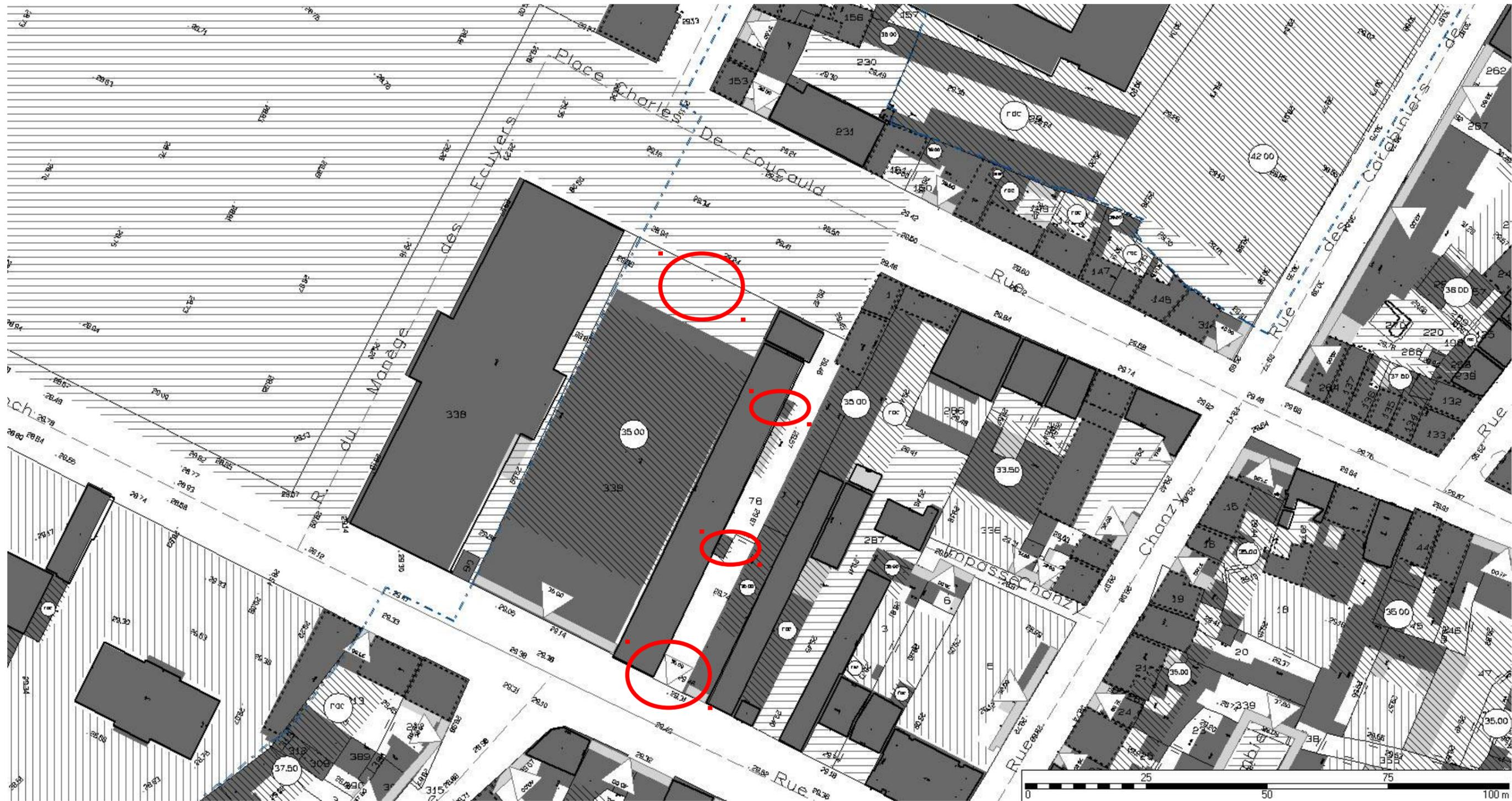
Il est proposé d'adapter le plan au projet en reportant la cote d'égout sur la façade sur la rue Beaurepaire et en supprimant les cotes inutiles pour les édicules de la cour et l'alignement de la place de FOUCAULT
