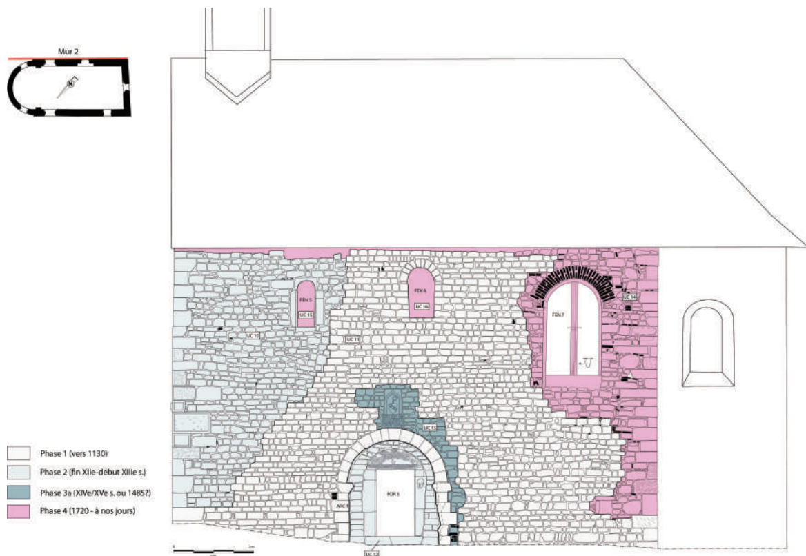
Fig. 2 : Relevé de la face sud-est de la chapelle avec indications des phases (© relevé : B. Dottori, F. Bricka ; DAO : P. Girard, Inrap).
