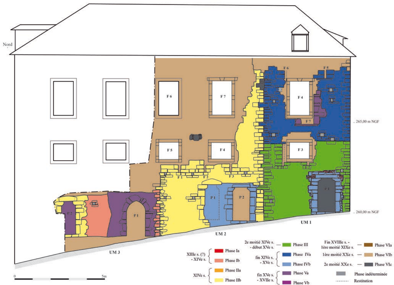
Elevation extérieure de la façade occidentale des trois bâtiments médiévaux.
