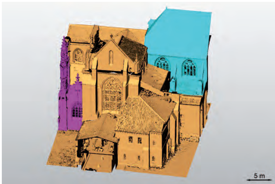
Figure 8 : Application de couleurs à des nuages de points segmentés offrant la possibilité de légender le modèle 3D (Auteur : Olivier Veissière).
