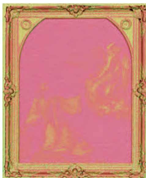
Figure 11 : Rendu d'un sujet brillant en intensité en fausses couleurs, basse résolution exploitée avec Trimble Realworks viewer (Auteur : Olivier Veissière).
