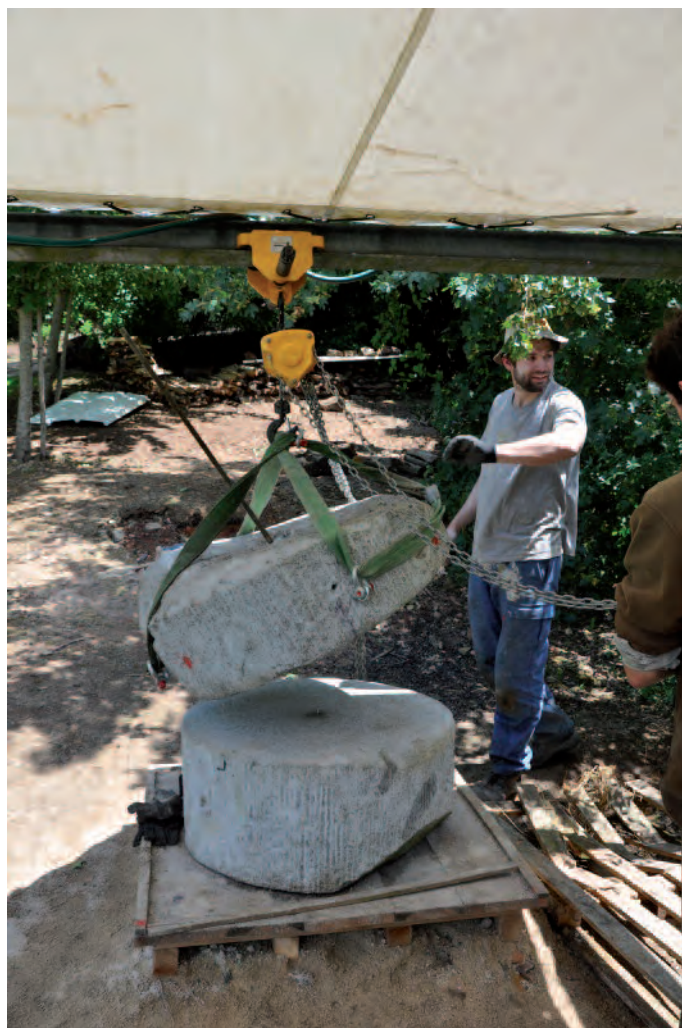
Melle, expérimentation de broyage de minerai au moulin : mise en place de la meule mobile (cliché : F. Téreygeol).
