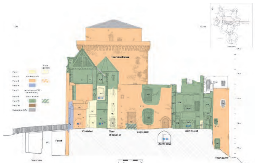
Saint-André-sur-Sèvre, château de Saint-Mesmin : coupe est-ouest dans l'axe du châtelet et vue vers le sud avec proposition de phases (DAO : P. Bouvart).
