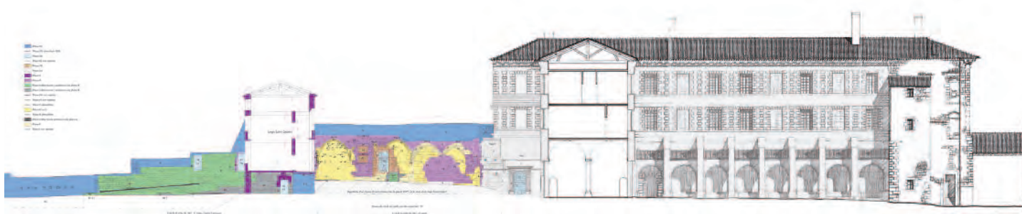
Celles-sur-Belle, bâtiments conventuels de l'abbaye : relevé de l'élévation occidentale des murs M1 et M2 avec proposition de phases (DAO : P. Bouvart).
