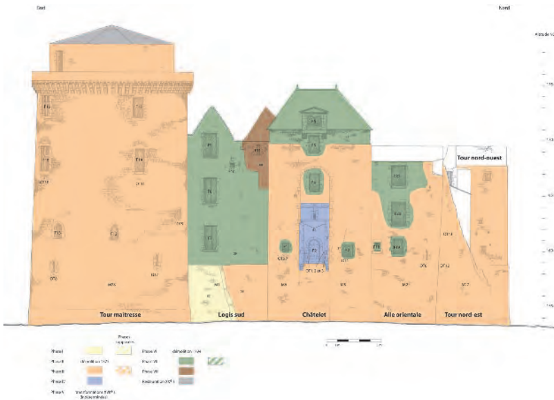
Saint-André-sur-Sèvre, château de Saint-Mesmin : élévations extérieures orientales avec proposition de phases (DAO : P. Bouvart).
