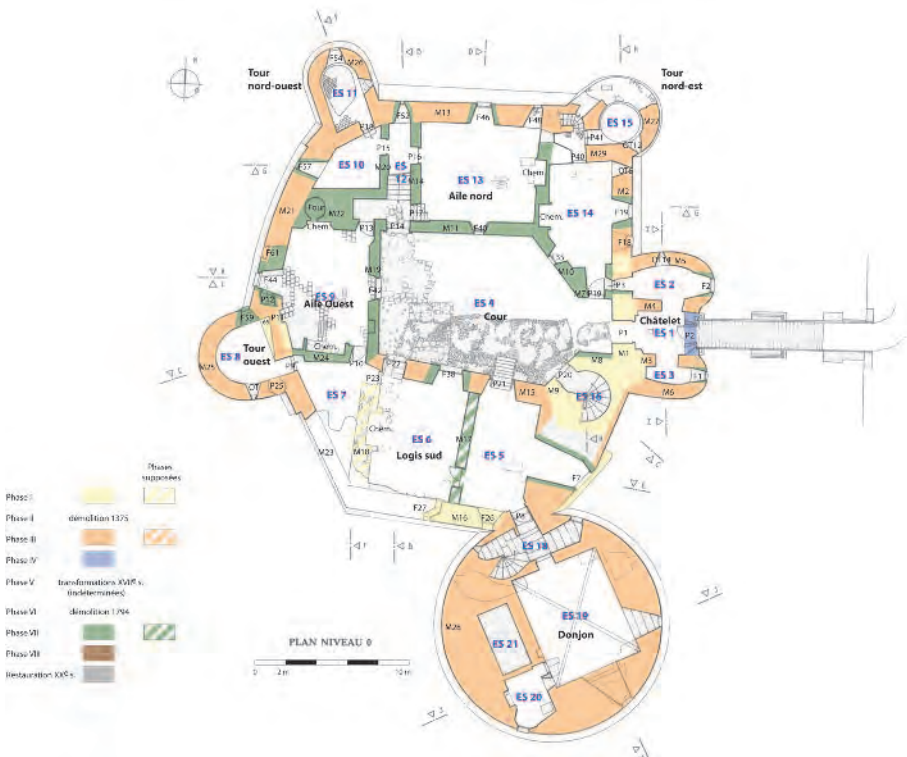
Saint-André-sur-Sèvre, château de Saint-Mesmin : plan du rez-de-cour avec proposition de phases (DAO : P. Bouvart).
