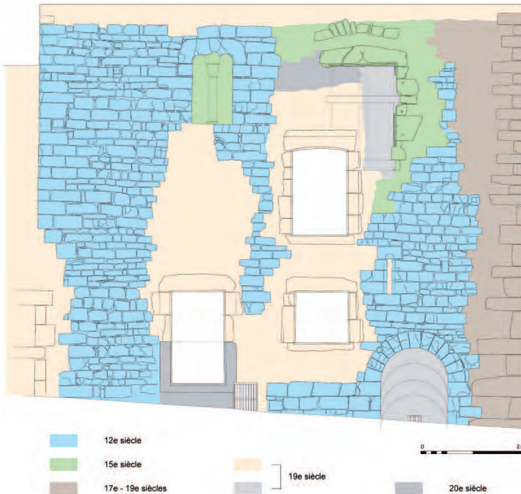
Charroux, maison romane : relevé de la façade ouest (DAO : L. Prysmicki).
