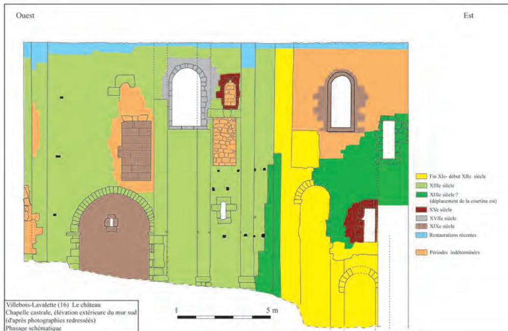
Villebois-Lavalette, le château - Chapelle castrale : élévation extérieure du mur sud (d'après photographies redressées). Phasage schématique (DAO : A. Montigny).
