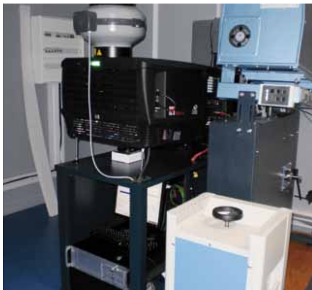
Cabine des Elysées à Issoudun (Indre) A droite le projecteur 35 mm, à gauche le nouveau projecteur numérique.
