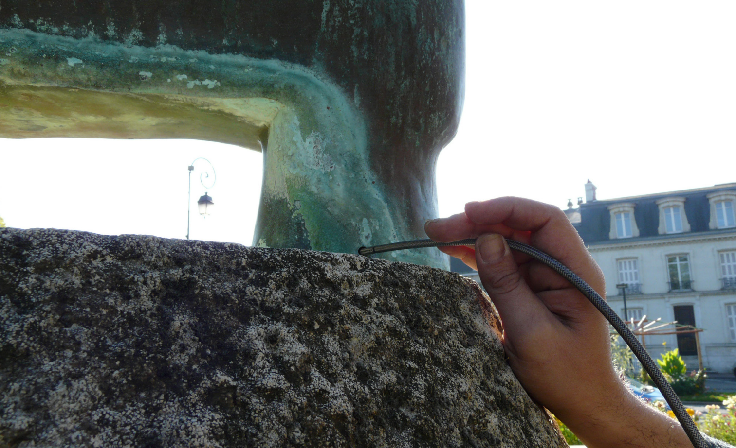
Fig. 3 : l'endoscope numérique est introduit dans la patte droite de la Grande grenouille , octobre 2010.
