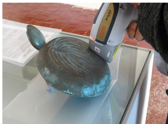
Fig. 6 et 7 : analyse par fluorescence X du socle et de la carapace d'une des petites tortues déposées à Tours, octobre 2010.
