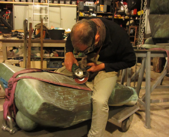
Fig. 4 : découpe de trappes pour pouvoir accéder à l'intérieur des bronzes.
