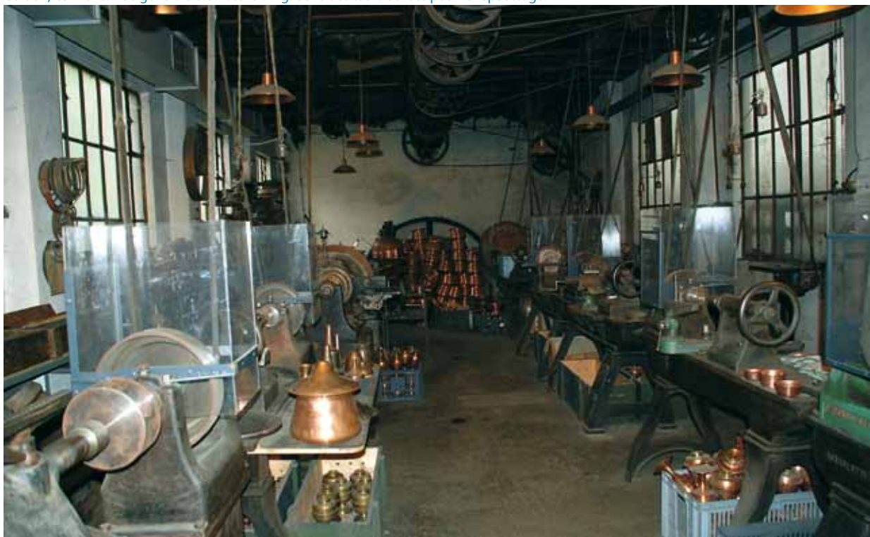
Cerdon, cuivrerie. Vue générale d'un atelier. À gauche des tours utilisés pour le repoussage.
