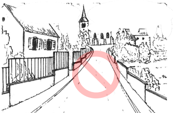
Décrochement de clôture à éviter.
