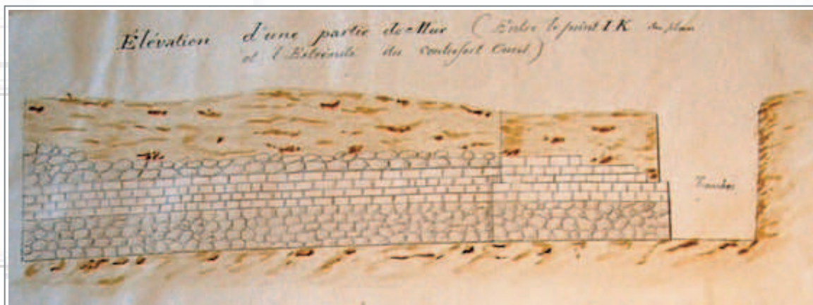
Aquarelle du mur de ceinture en petit appareil avec chaînage de briques
