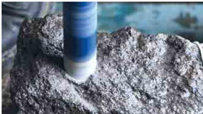
Meule en basalte en cours de carottage. Le cylindre de roche prélevé est envoyé à l'institut de géologie de l'Université de Mayence pour en déterminer sa provenance par le biais de son signal physico-chimique (B. Robin).
