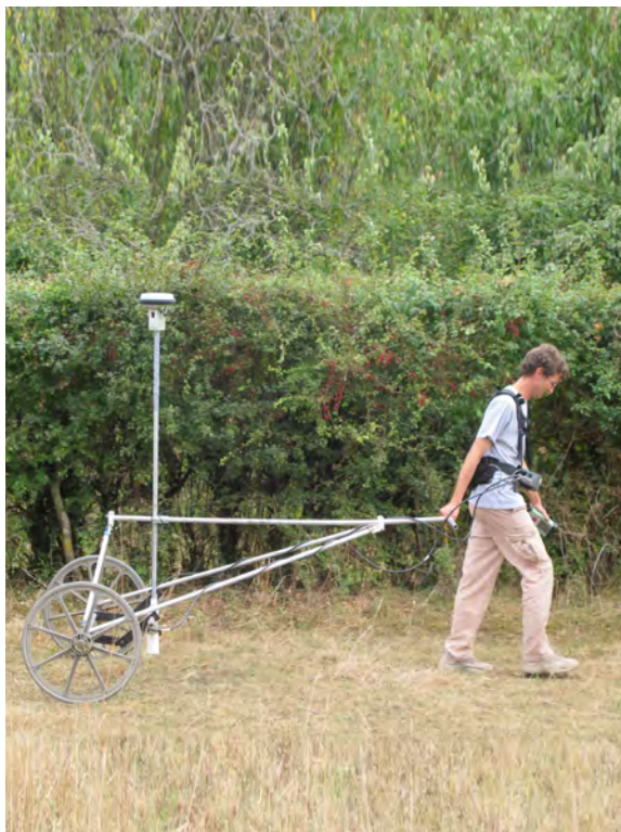
Campagne de prospection par méthode magnétique, couplée à un GPS © PCR Vesvre.
