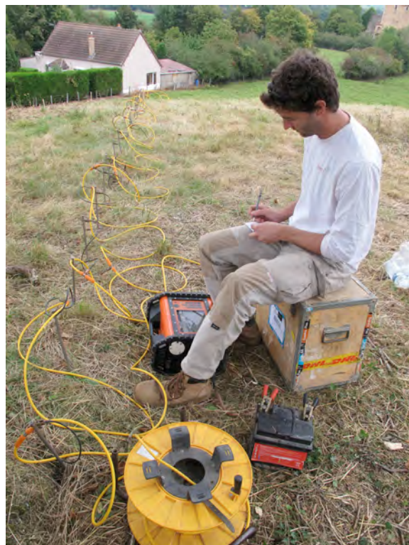
Mise en place des électrodes pour mesurer la résistivité du sol sur la motte © PCR Vesvre.
