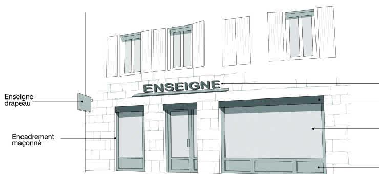
Schéma vocabulaire – devanture en feuillure
