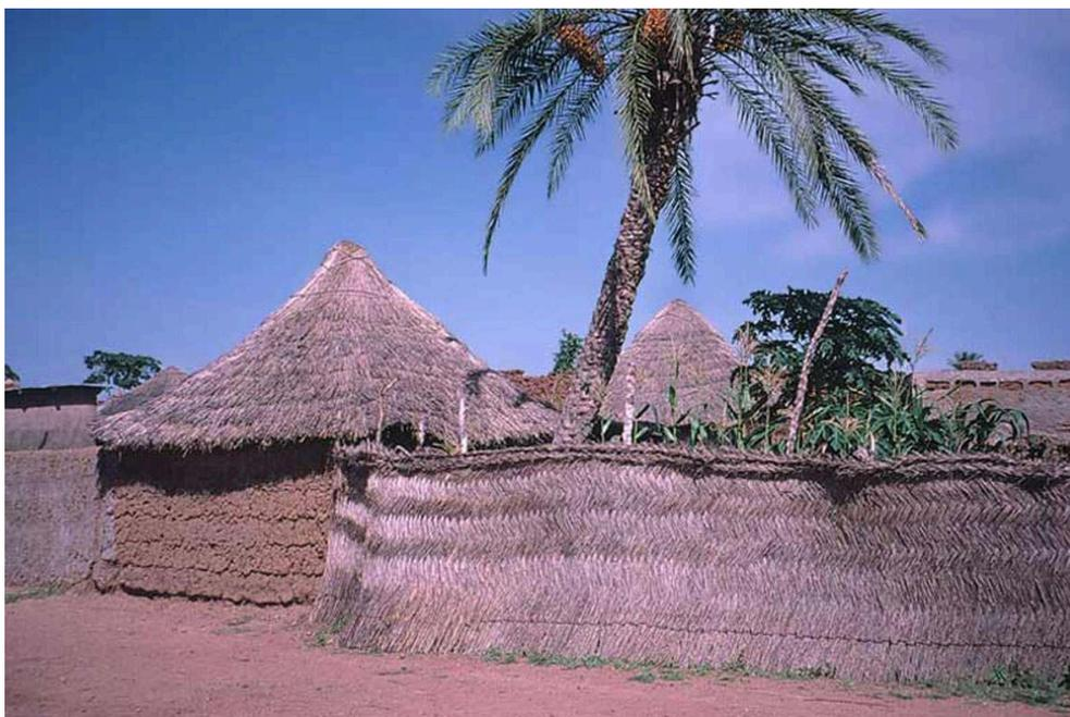
Rey Bouba. Matériaux traditionnels utilisés dans la construction d'un *saré* ou concession familiale : terre, chaume et panneaux de vannerie ou *sekkó*
