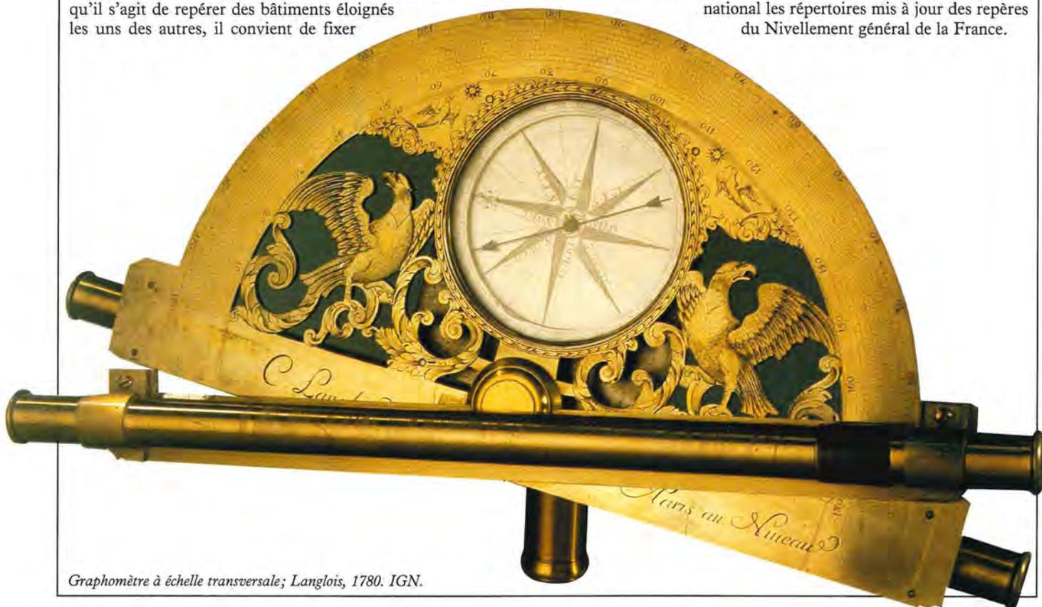
Graphomètre à échelle transversale; Langlois, 1780. IGN.
