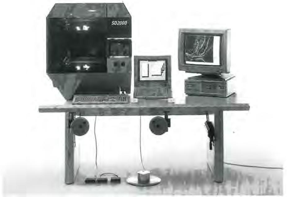
l'appareil est due en grande partie à la superposition des deux clichés sur la gauche de l'appareil ; avec cette superposition disparaît le dernier signe analogique — cliché gauche, cliché droit — qui subsistait. Deux cartes électroniques contrôlent la quasi-totalité des fonctions optomécaniques. Le logiciel tourne sur un PC et contrôle toutes les phases de l'opération de l'analyse jusqu'au transfert des données vers des logiciels d'application.
