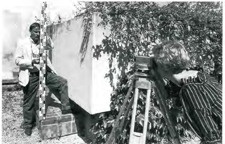
La lecture sur la mire est directe ; la différence de niveau  $d_n$  du point [A] par rapport aux points [B], [C], ... s'effectue par différence algébrique des lectures sur les points [A], [B], [C], ... :  $h_A, h_B, h_C$ .
