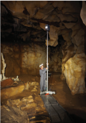
[1] Exemple de relevé lasergrammétrique à la grotte Chauvet.
