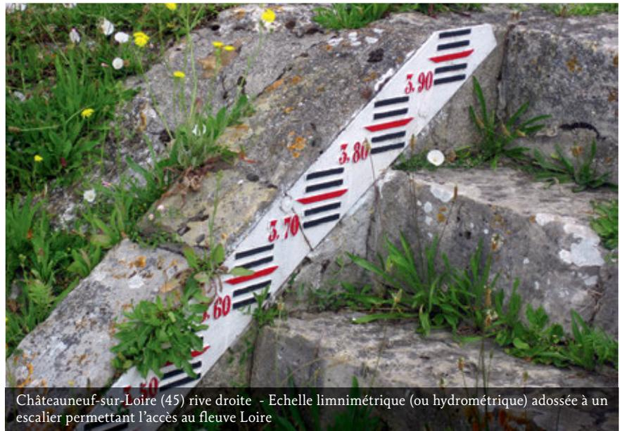
Châteauneuf-sur-Loire (45) rive droite - Echelle limnimétrique (ou hydrométrique) adossée à un escalier permettant l'accès au fleuve Loire
