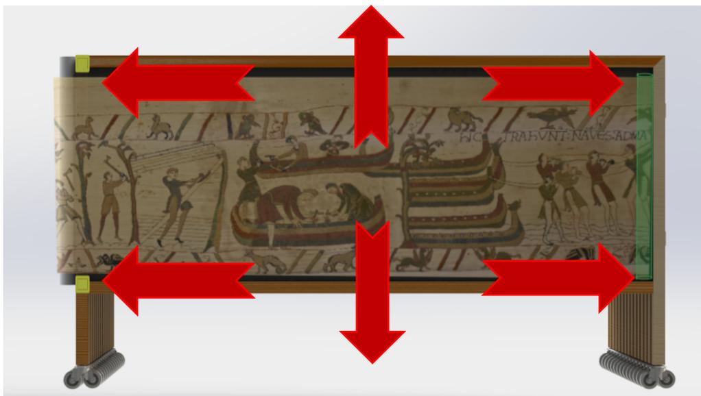
Figure 11. Représentation des risques mécaniques liés au conditionnement sur le support de transfert : mouvements des panneaux, va-et-vient horizontaux et verticaux.
