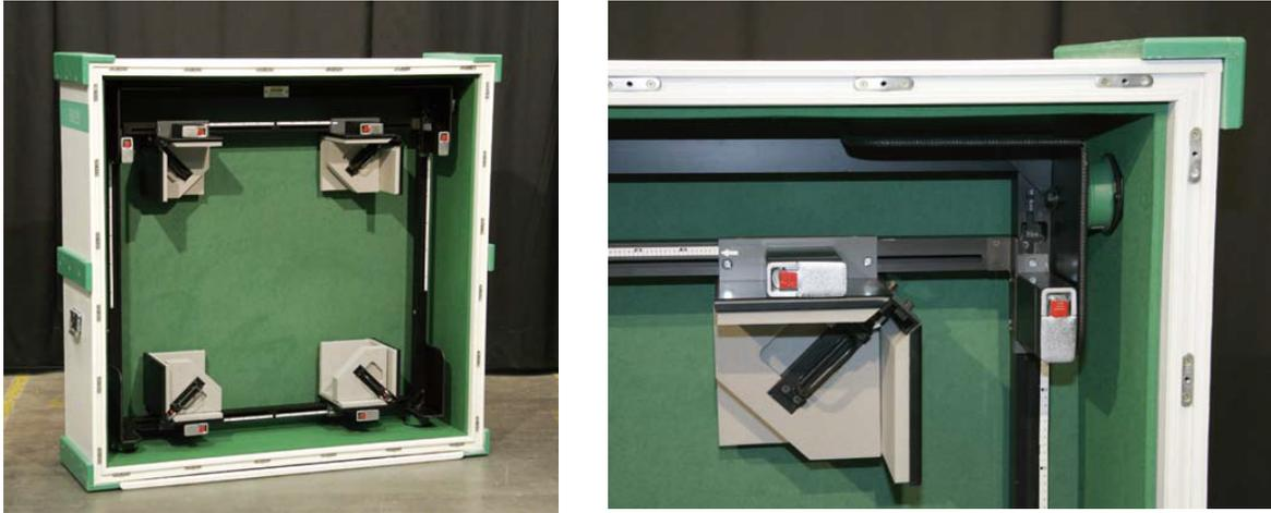
Figure 30 : Caisse “Vario-System” développée par la société de transport Hasenkamp. Cette caisse est réutilisable et s’adapte à différents formats grâce aux coins ajustables. L’amortissement des vibrations est garanti par des amortisseurs élastomères, places entre la caisse externe et le châssis rigide en aluminium (détail à gauche).
