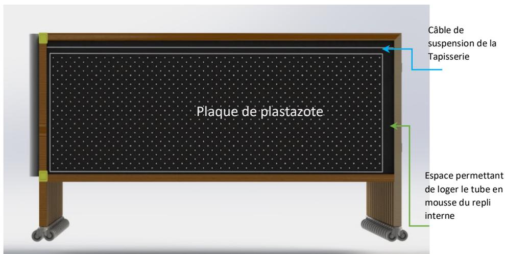
Figure 14 : Habillage des panneaux de polycarbonate par des plaques de mousse de plastazote® (Réalisé en amont de l'extraction).
