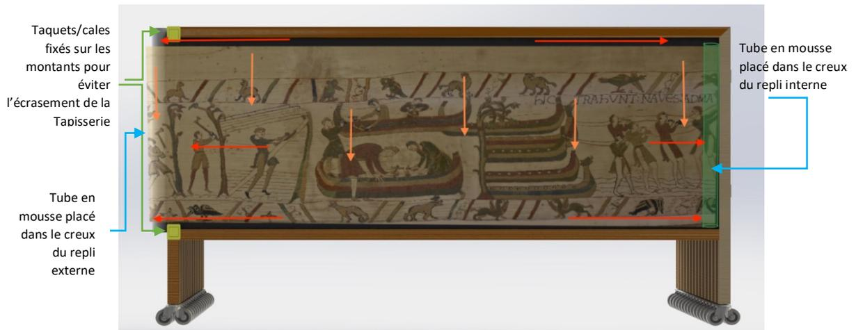
Figure 20 : Emplacement des taquets/cales séparateurs et des tubes en mousse (PE) pour éviter tout risque d'écrasement.
