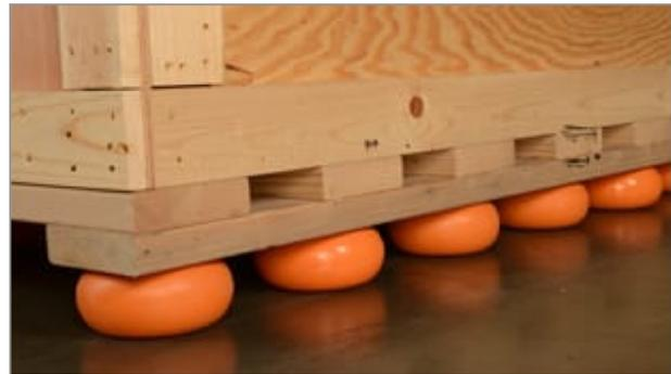
Figure 37: Utilisation de plots sous une caisse externe de transport.
