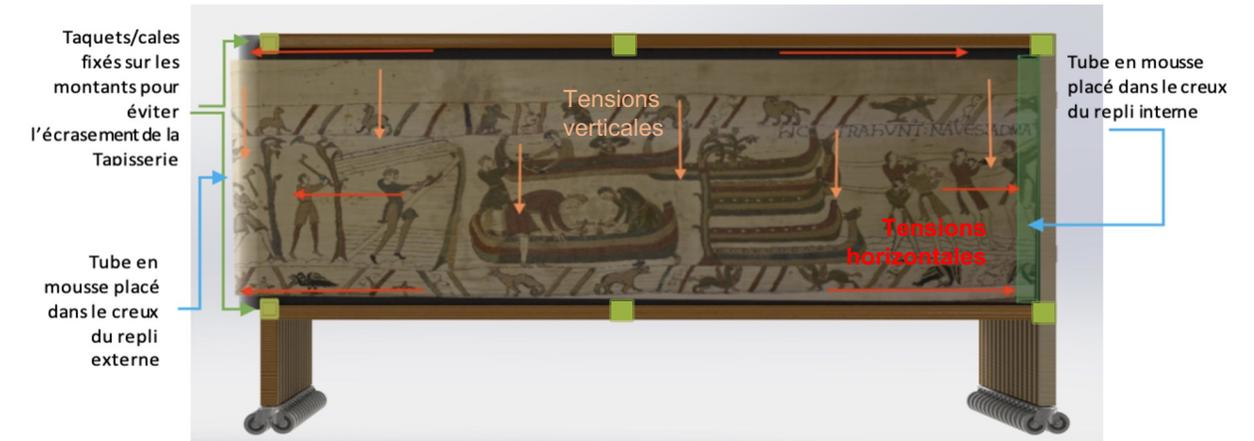
Fig. 4 : Risques de tensions verticales et horizontales. Emplacements des tubes en mousse PE pour éviter tensions et plis aux extrémités.
