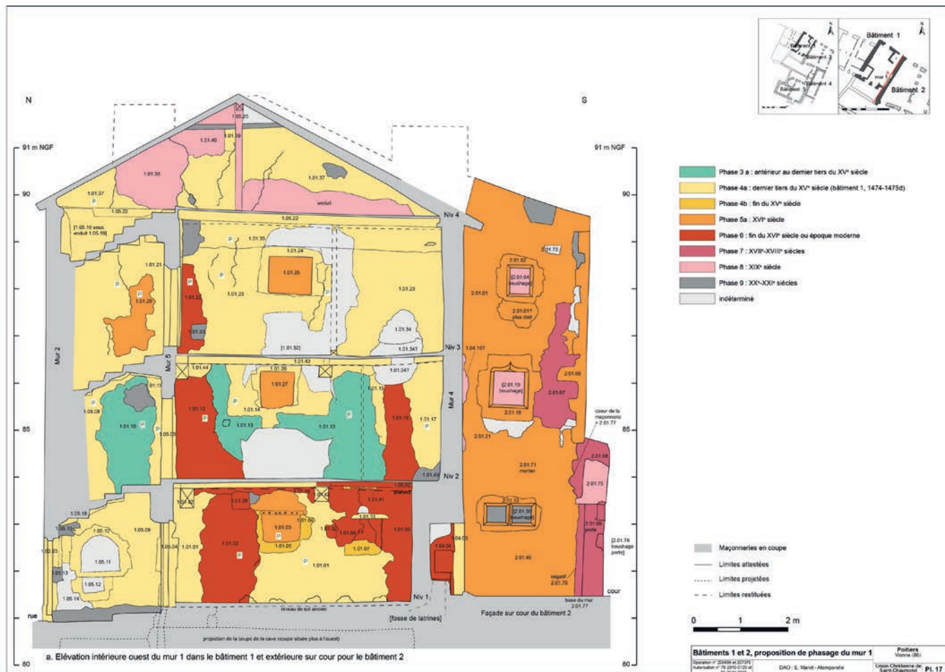
Poitiers, 27 et 29 rue des Carolus, 1 et 3 rue Arthur-de-la-Mauvinière, fig. 2 : Proposition de phasage du mur est du bâtiment 1 (DAO : E. Marot)
