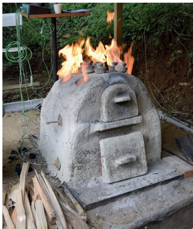
L'expérimentation paléométallurgique, four de fonte et de coupellation dit « aux sept étoiles », Yunnan, XVIIIe s. (cliché : F. Téreygeol)
