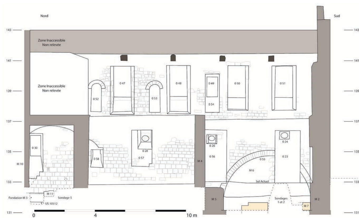
LE BUISSON-DE-CADOUIN - Abbaye de Cadouin. Mur oriental du bâtiment est avec implantation des sondages 1 et 2 à l'ouest et 5 à l'est. (© J.-B. Javel).
