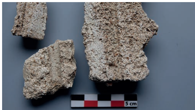
De Cassinomagus à Chassenon, joints regarnis recouverts d'un lait de chaux (cliché : A. Coutelas).
