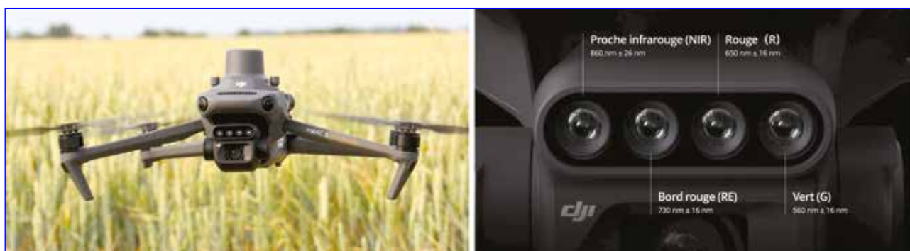
Figure 3 - Drone DJI Mavic 3M en vol (à gauche, cl. © F. Besse 2023) et caméras multispectrales (crédit image : DJI).
