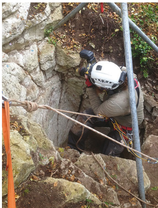
Scorbé-Clairvaux - Relevé photogrammétrique en rappel dans le puits (cliché F.Leleu, Arkémine).
