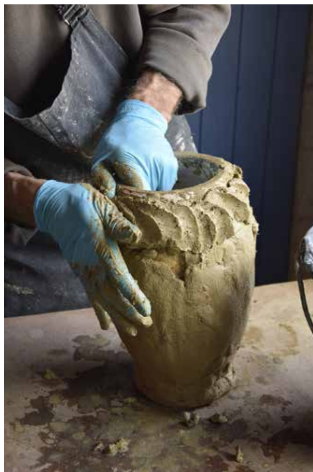
L'expérimentation paléométallurgique : mise en place d'un lut sur un creuset de cémentation d'après un modèle du III e s. n.e. trouvé sur le site du Clos-Paul à Charleville-Mézières (08).
