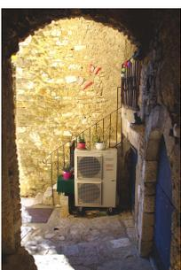
Bloc installé sans recherche de dissimulation (St Montan)
