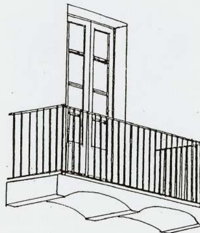
Balcons ajoutés au cours du XIXème siècle sur les façades reconnaissables à leur structure de fers et voûtains de brique
