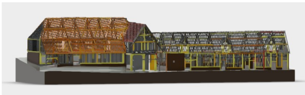
Ferme du château de Saint-Germain-de-Livet / Structure bois – maquette numérique 3D – vue des pathologies (A-BIME©)
