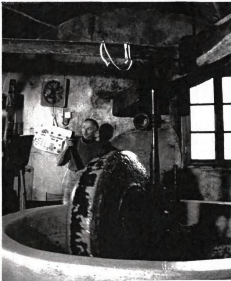
Photo N°55 : La "pierre" ou la meule actionnée par la force hydraulique
