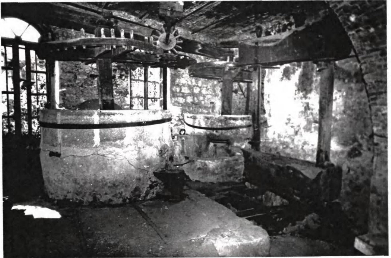
Photo N°35: Moulin traditionnel à la cuve en bâti cylindrique, vis de bois et meule simple (Trans en Provence - Var) (cliché S. DETOT)
