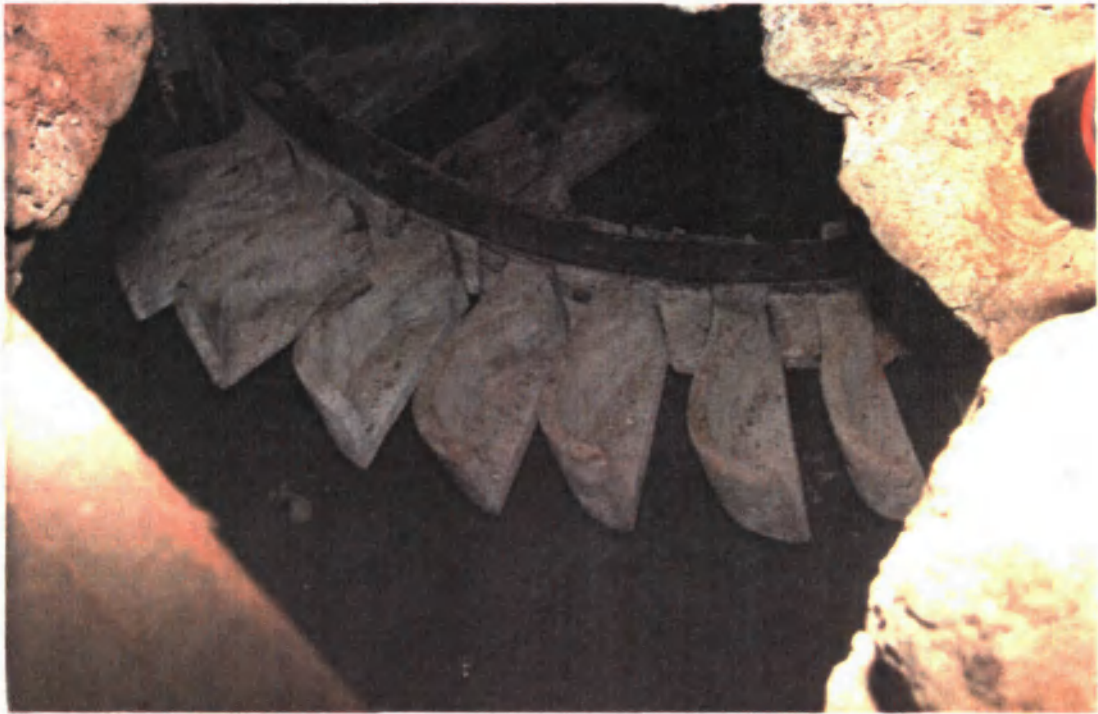
Photo N°37 : Roue à cuillères (Trans en Provence - Var)
