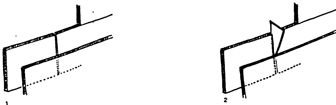
Fig. 26. Calfatage d'un écart recouvert partiellement par le doublage en bois. 1. Préparation de la couture 2. Mise en place d'un bout de bardeau en pin dans la couture.
