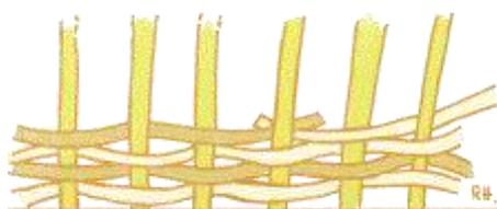
Fig. 14 – Schéma du tressage : 1 brin, derrière 1 devant 1
