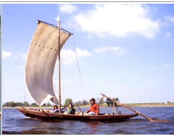
Premières navigations sur Port-Ligny à l'été 1988. Mât 6,30 m, voile en coton 18m 2 dotée d'une bande de ris, cordages en chanvre. 37 ans plus tard, la voile d'origine est toujours fonctionnelle. Cl.Ellébore.
