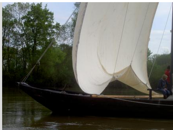
Sur les bateaux récents, le boitas est constitué d'une grosse perche transversale, amarrée au niveau du bordé par un cordage (hale-bas) pris sur les courbes. La Fillonnerie, Rencontres Voiles de Loire 2008, Sainte-Gemmes-sur-Loire. Cl. Ellébore.
