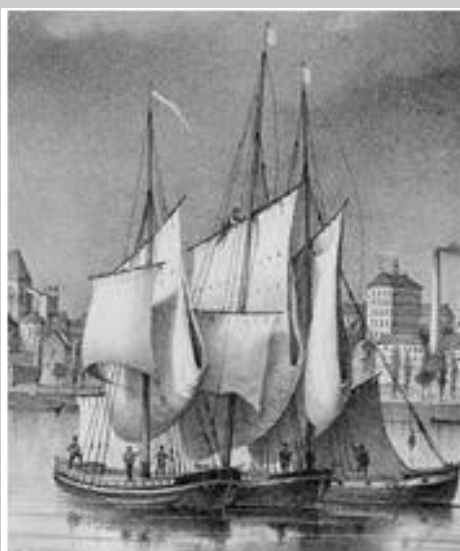
Trois bateaux accélérés font sécher leurs voiles hissées à demi. On remarque la forme arrondie des coques et la balustrade qui sert de pavois. -id.-
