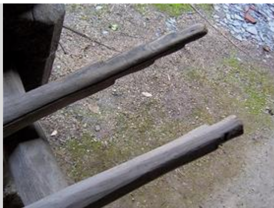
Extrémité de deux vergues de 4 à 5 mètres conservées dans un ancien atelier de charpentier en bateaux à Combleux (45). On notera les taquets de formes différentes destinés à tendre la voile. Coll. Part, cl. Ellébore.
