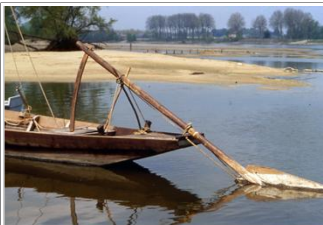
Détail de la piautre du fûtreau Port-Ligny. Conçue par François Ayrault, elle a été réalisée en 1988 par Guy Brémard pour l'association angevine Ellébore, quelques mois après le premier essai de gréement carré sur le fûtreau Fi-de-Galarne par le musée du Bateau de Douarnenez. Cl.Ellébore.
