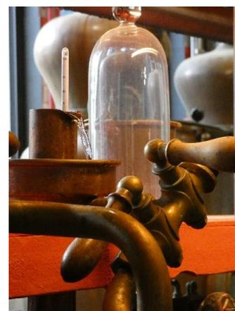
*Distillation en alambic de cuivre de type alambic à repasse : écoulement du distillat © Catherine Virassamy 2023.*
