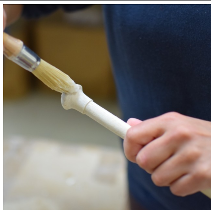
Illustration 8 : Application du verni au pinceau et séchage des manches de cravaches. © 2024, Nils Lišnić
