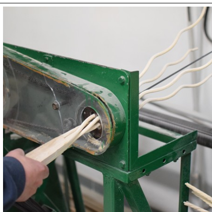
Illustration 4 : Le pédalier de vélo permettant de desserrer momentanément les brins afin d'en retirer la tige métallique. © 2024, Nils Lišnić
