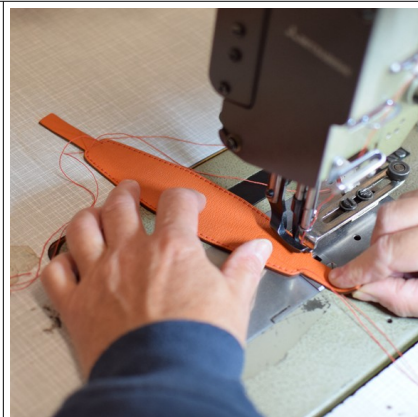
Illustration 10 : Couture d'une boucle de cravache Hermès. © 2024, Nils Lišnić
