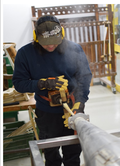
Tressage du bois de micocoulier au moyen des étuves à vapeur.
