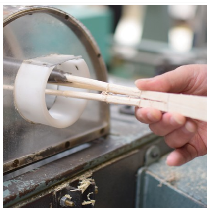
Illustration : Un travailleur de l'ESAT en train d'utiliser la machine Giret pour arrondir les brins. © 2024, Nils Lišnić
