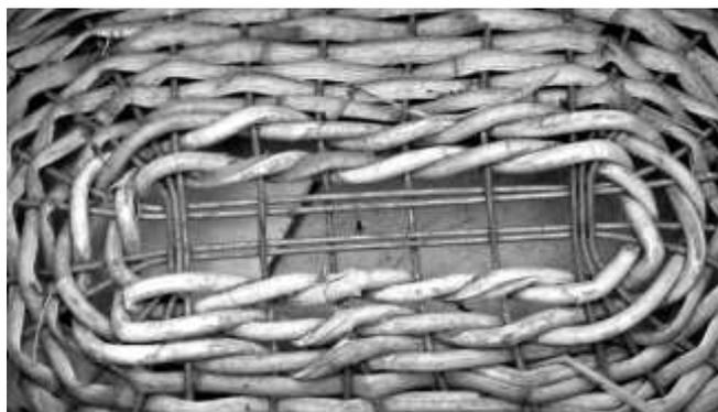
Fig. 12 – Croisement des montants en fil de fer au fond d'une manne à chalut, fabrication de Pierre Guernalec à Rosporden, Finistère
