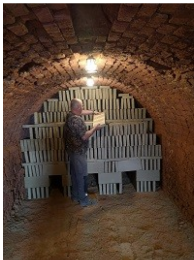
L'enfournement des cayrous à la Briqueterie Sainte-Marcelle à Saint-Jean-Pla-de-Corts. © J.-B. Carrère, 2019.
