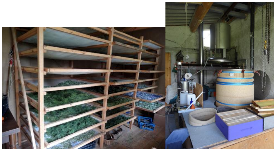
Fig. 2. Séchoir à claies (à gauche) et alambic (à droite). © Inès Gayral, 2018.
